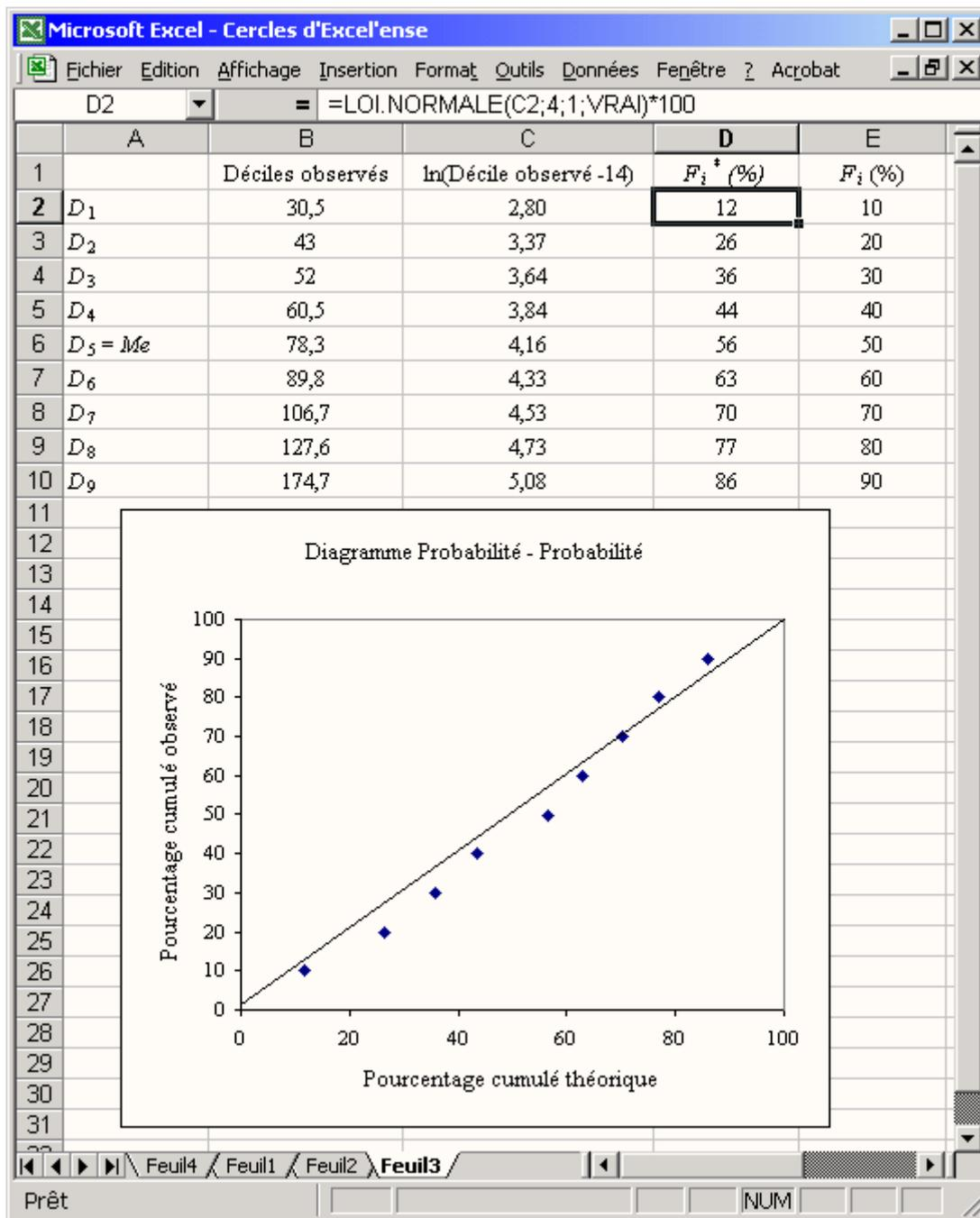
Figure 3 : Ajustement d'une distribution de durées d'appel téléphonique par une loi log-normale
